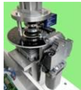
Détail de la motorisation du suiveur solaire
