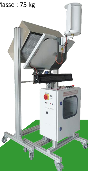
Système Soléotec XM avec éolienne à axe vertical et éclairage artificiel indépendant
